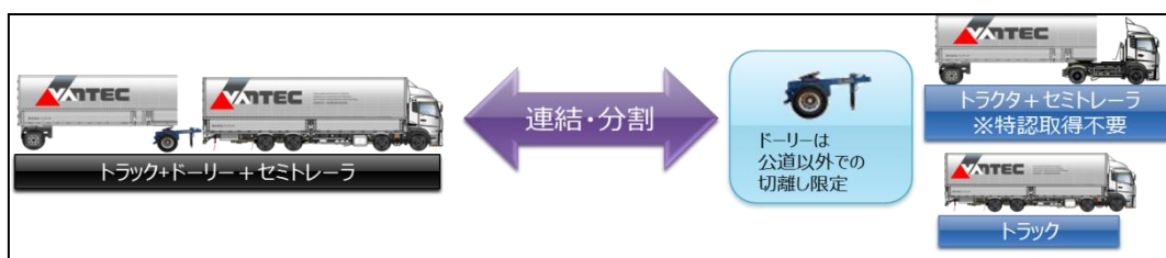
図- 3 全長 21m ドーリー連結・分割式ダブル連結トラック 特徴
