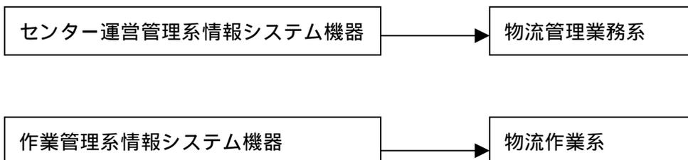
註．作業管理系情報システム機器には、コンベアや仕分機器等の物流制御系も含む。
