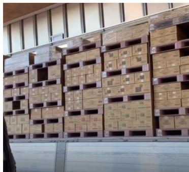
図3 メーカー出荷時におけるミルフィーユ積載の例
